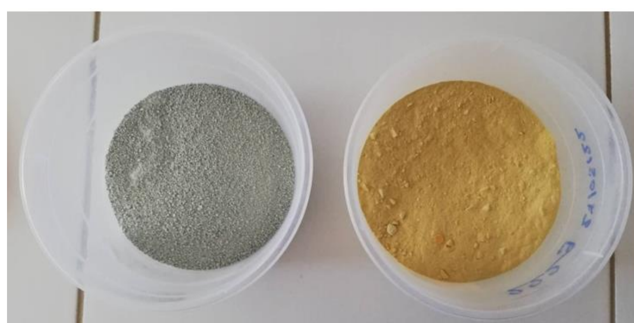
Εικόνα 1. Αριστερά ο φυσικός ζεόλιθος και δεξιά ο τροποποιημένος ζεόλιθος
